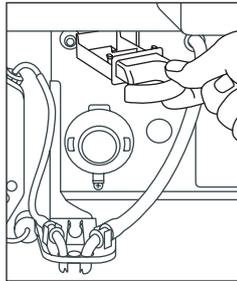
>>5 Nach Demontage der Mischschale und Produktrutschen den Absaugkanal entnehmen und reinigen.
