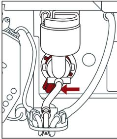
>>1 Bajonettverschluss der Mischschale ③ (oranger Hebel) unten nach links drehen.
