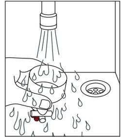
>>3 Warmes Wasser und HACCP Reiniger lösen die Produktrückstände zuverlässig. Keine rauen Reinigungsschwämme verwenden.
