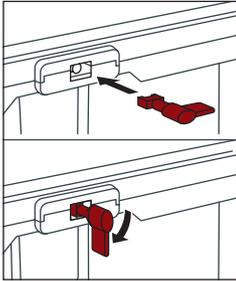
>>1 Türkontaktschlüssel einstecken und durch 90° Drehung nach unten das Gerät einschalten. Warten bis das Gerät betriebsbereit ist.
