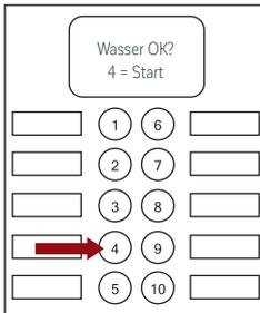
>>4 Sicherheitsabfrage 2: Wassertank befüllt und eingesetzt? Wenn ja, Taste 4 drücken.
