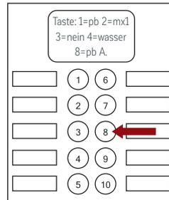
>>5 Auswahl des Reinigungsprogramm für Brüher = Taste 8 drücken. Die Spülung wird dann aktiviert.
