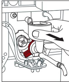
>>2 Die Mischschale nach vorne abziehen und Schlauch aus der Halterung drücken. Entnehmen Sie den Dampf-ring von der Mischschale.
